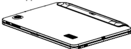
2. Öffnen Sie die Halterung an der Rückseite des Tablets.
