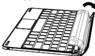
2. Stecken Sie das Tablet in die Halterung und befestigen Sie es.
