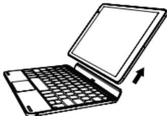
Hinweis: Die Halterung kann nur bis zu einem bestimmten Winkel aufgeklappt werden. Klappen Sie das Tablet daher nicht mit Gewalt oder sehr schnell auf.
