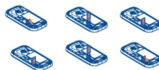
Pour dégager le support de la carte microSD, faites-le glisser dans le sens de la flèche et soulevez-le. Insérez alors la carte microSD, la face du contact doré vers le bas. Enfin, retournez le support de la carte microSD et faites-le glisser dans le sens inverse pour le bloquer.
