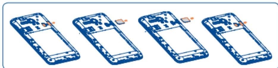
Coloque la tarjeta SIM con el chip hacia abajo y deslícela en su alojamiento. Verifique que esté correctamente insertada. Para extraer la tarjeta SIM, presiónela y deslícela hacia afuera.
