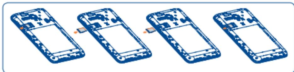
Coloque la tarjeta microSD con el chip hacia abajo y deslícela en su alojamiento. Verifique que esté correctamente insertada. Para extraer la tarjeta microSD, presione suavemente y deslícela hacia afuera.
